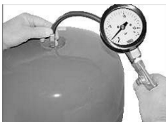
Рис. 6 Контроль давления в мембранном баке
