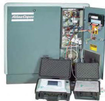
Пример: измерение потребляемой компрессором энергии и регистрация измеренных значений
