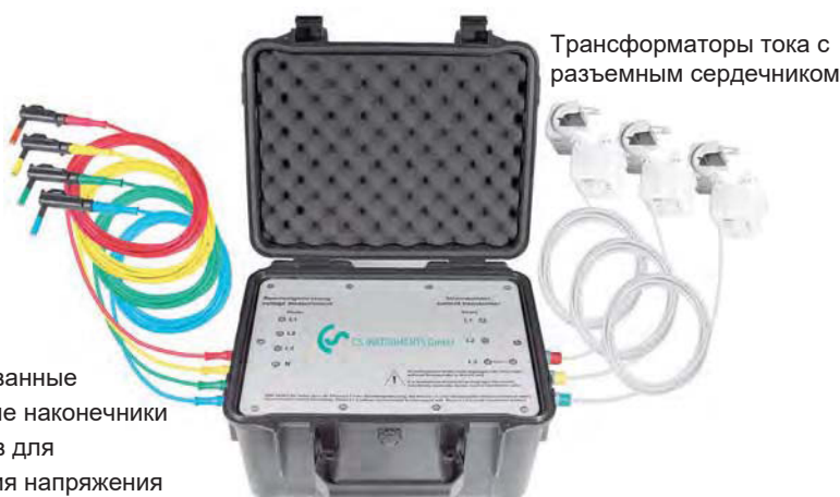
Пример: измерение потребляемой компрессором энергии и регистрация измеренных значений
