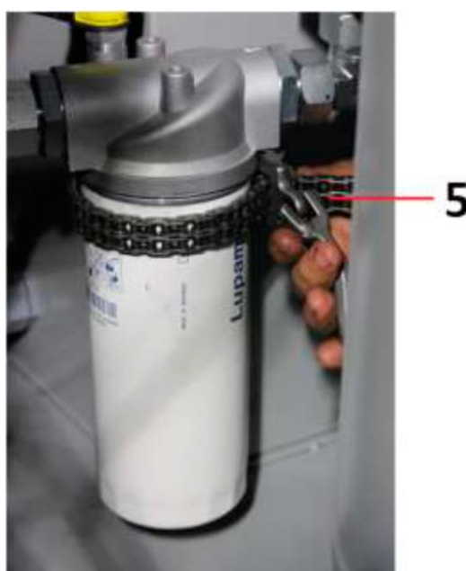
Рисунок-9 Снятие фильтрующего элемента масляного фильтра
