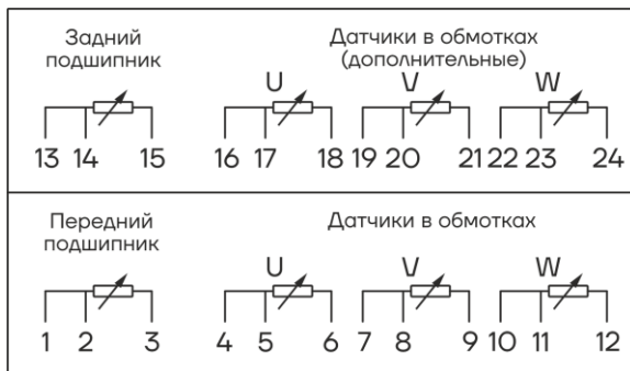
Рис. 7. Схема подключения датчиков температуры PT100
