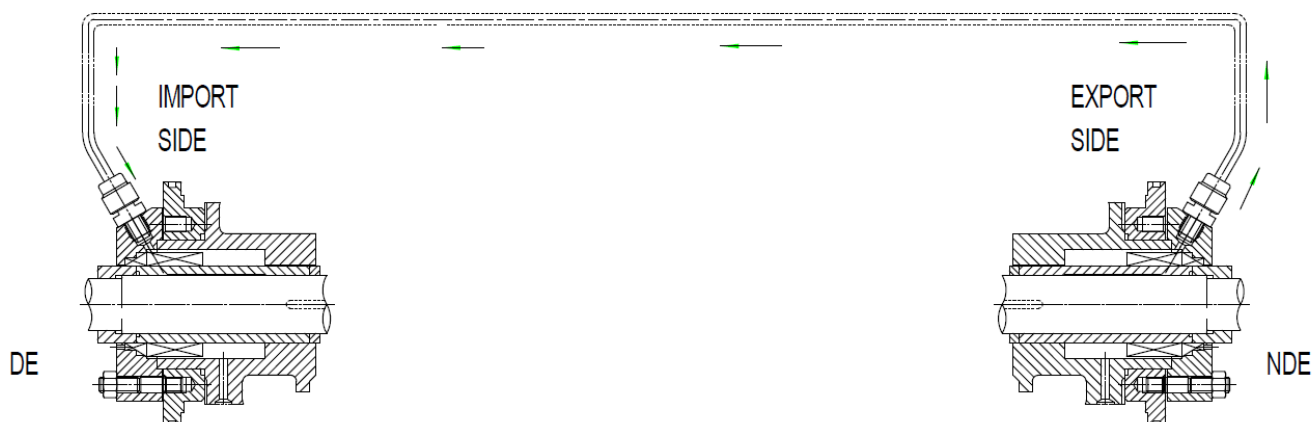
Схема промывки торцевых уплотнений (внутреннее подключение)
