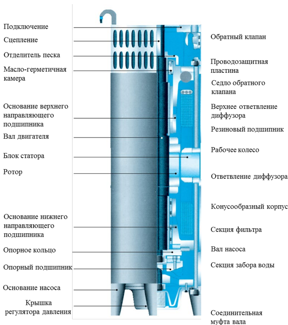
Рисунок 12. Структура двигателя погружного агрегата насосного SM
