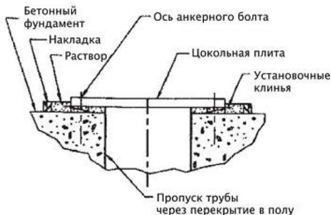
Рис. 6 Установка плиты по уровню
